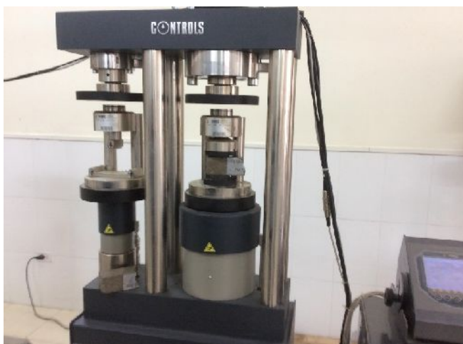
Рис. 2. Определение прочности образцов на сжатие
