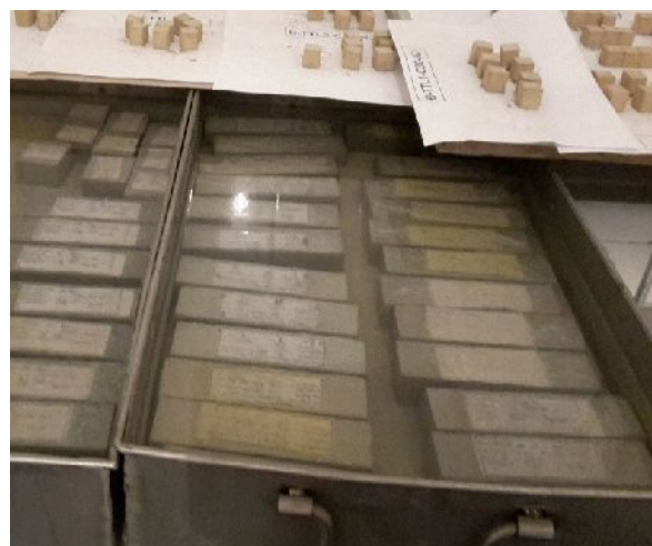
Рис. 3. Экспериментальные образцы из цементно-шлаково-песчаных растворов
