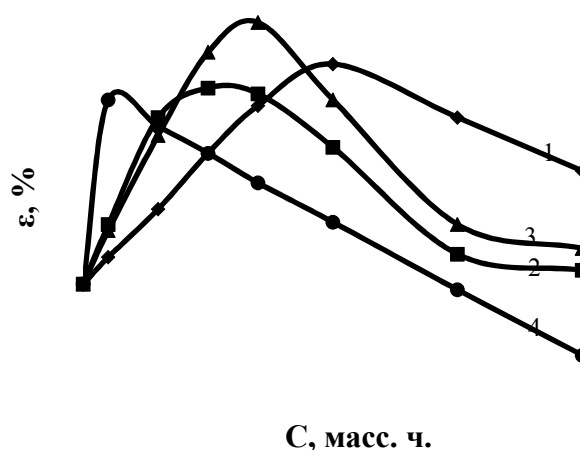
Рис. 5. Зависимость деформации при разрыве ( \varepsilon_r ) пленочных образцов от количества введенного олигосульфона: Б-3-К (1); Б-6-К (2); Б-10-К (3); Б-50-К (4) Образцы отверждены по режиму I
